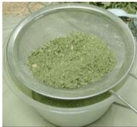
Fig. 2. Hasil pengamatan visual eceng gondok setelah dilakukan pengeringan oven dengan suhu 130°C selama 30 menit.
